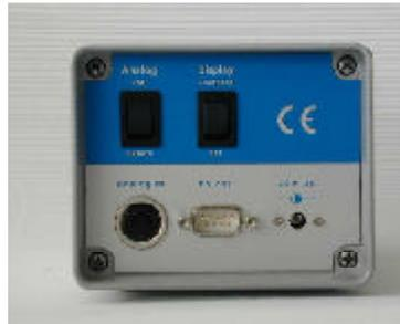
リアパネルのスイッチで、ポテンシオメーターを使用するローカルコントロールと0-10V 外部入力またはRS-232経由PCコントロールを切り替えます。
