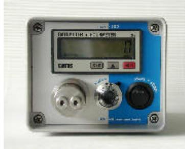
フロントパネル上には、ON/OFFスイッチ、手動フロー制御用精密チューニングポテンシオメーターが配されています。ポンプヘッドはパネルを介してモーターに直結されているか、またはパネル上にポンプ接続ケーブルのコネクターが搭載されます。
