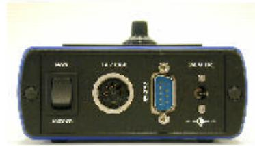
リアパネルのスイッチで、ポテンショメーターを使用するローカルコントロールと0-10V 外部入力またはRS-232経由でP Cコントロールを切り替えます。
